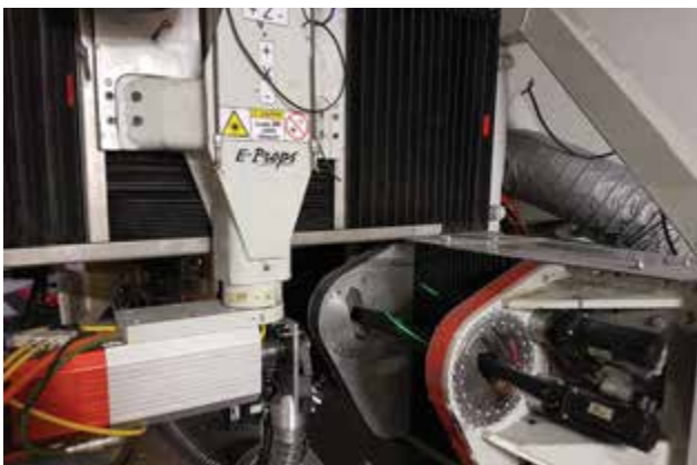
Centre d'usinage TRM-8 : contrôle dimensionnel avec un scanner laser puis finition de chaque pièce (ici une pale d'hélice pour Rotax 912S)
