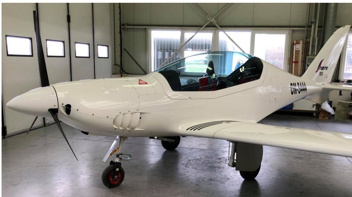
SHARK 100 cv avec E-PROPS tripale pas réglable DURANDAL 100-M
